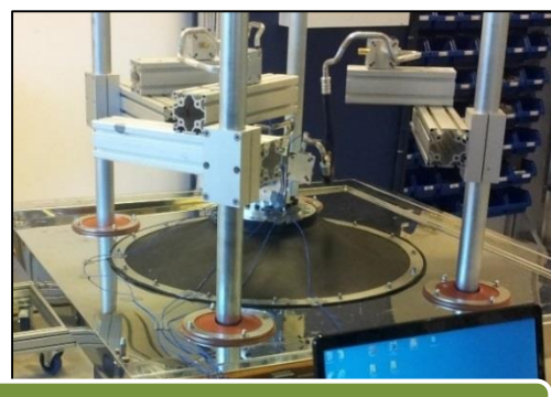
Prüflingsaufbau außerhalb der Kammer (nur mit beweglicher Prüfkammer)
