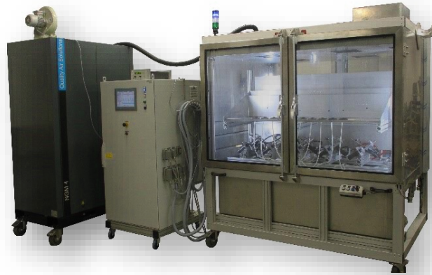
Die einzelnen Prüfstandskomponenten (Stickstoffgenerator / Steuerschrank / Prüfzelle)
