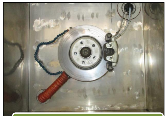
Antriebsachse in der Prüfkammer (Ansicht zeigt Bremssystem ohne Felge)
