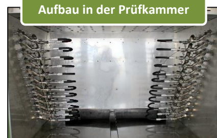
verstellbarer Achsabstand von 150 mm bis 450 mm
