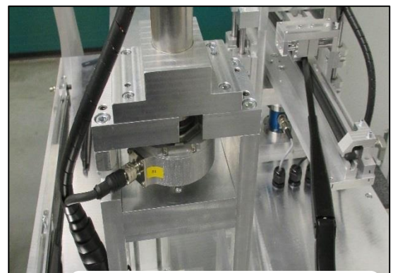
Aufbau der Prüfung (hier Wischerblattprüfung)
