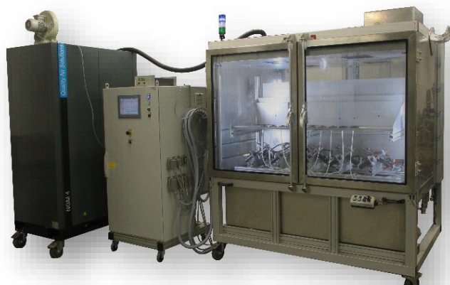
Die einzelnen Prüfstandskomponenten (Stickstoffgenerator / Steuerschrank / Prüfzelle)
