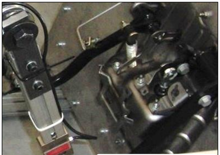
Pedaleinbau im Prüfstand
