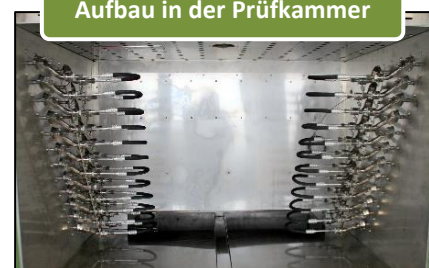
verstellbarer Achsabstand von 150 mm bis 450 mm
