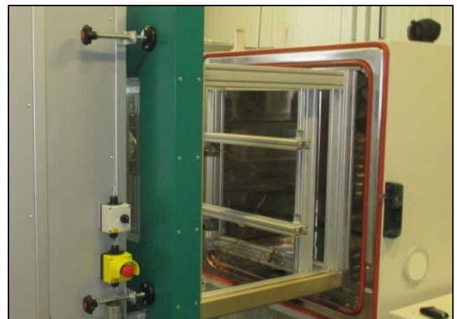
Einbringung in Prüfkammer (abhängig von der Prüfkammer)
